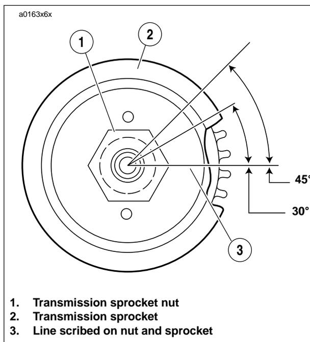
1. Transmission sprocket nut
