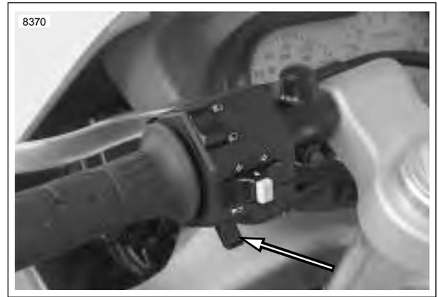
**Figure 7-68. Horn Switch**
